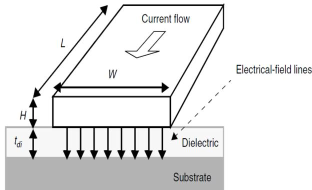
**PARALLEL-PLATE CAPACITANCE MODEL OF INTERCONNECT WIRE**
