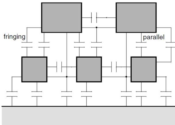
CAPACITIVE COUPLING BETWEEN WIRES IN INTERCONNECT HIERARCHY
