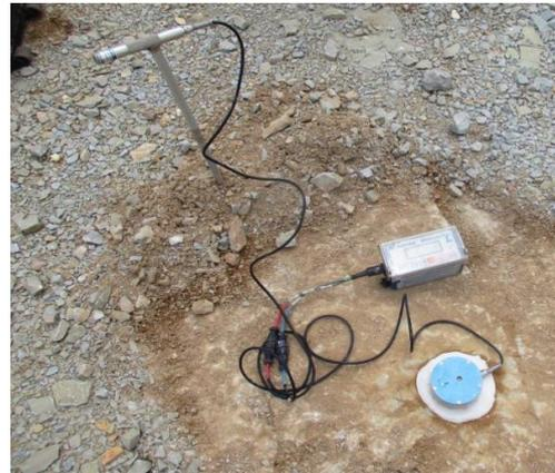
FIGURE VI. MONITORING OF GROUND VIBRATION
